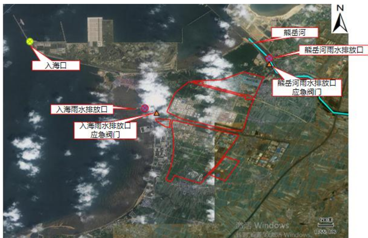
图 1.7-6 雨水排放口与应急阀门分布示意图
